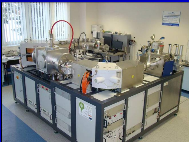
MICADAS ^{14}\text{C} AMS (ETHZ) 1s error < +/- 0.5%
